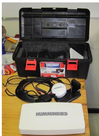
Figura No.5. Ecosonda y sus componentes.
