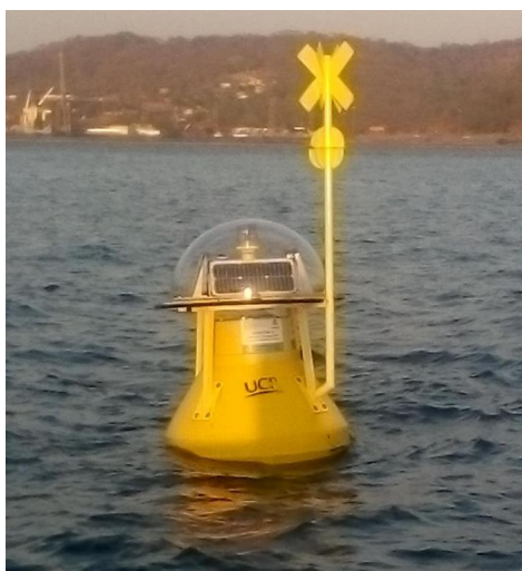
Figura No. 3. Boya de medición instalada en Caldera.
